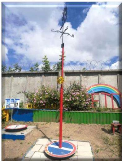
**Флюгер** в форме вращающейся на опорной оси "стрелке" позволяет наглядно показывать направление ветра по размещенному неподвижно указателю сторон света. Флюгарка состоит из лопасти и стрелки, укрепленных на трубе. На нижней части стержня находятся штифт для ориентировки направлений по сторонам света. К штифтам прикреплены буквы (С-Ю, З-В) для лучшей ориентировки детям. Ориентировка флюгера по сторонам света выполнена при помощи компаса.
