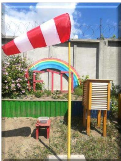
**Ветряной рукав** - указатель направления и силы ветра, который обычно устанавливается на аэродромах, его еще называют текстильный колдун. Позволяет определить силу ветра:
