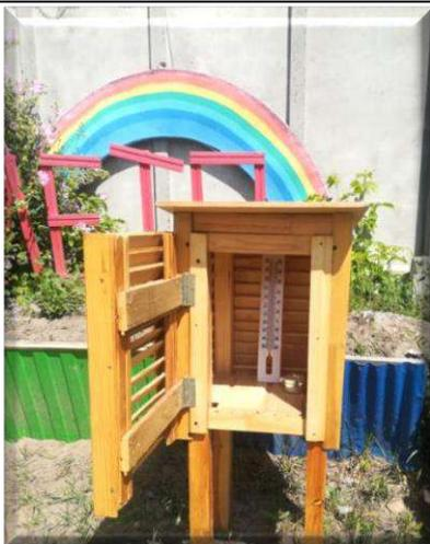
**Термометр** - позволяет определять температуру окружающего воздуха и изучать такие понятия, как "холодно", "жарко". Термометр укреплен на высоком металлическом шесте под прямыми солнечными лучами. Таким образом, мы узнаем температуру воздуха на солнце. Другой термометр находится в метеорологической будке, в тени. Это позволяет сравнивать температуру воздуха на солнце и в тени.
